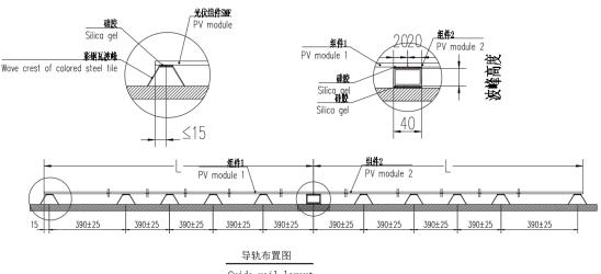
Guide rail layout 适用SMFxxxM/F-6X12UW.SMFxxxM/F-6X12DW. SMFxxxM/F-6X10UW.SMFxxxM/F-6X10DW
